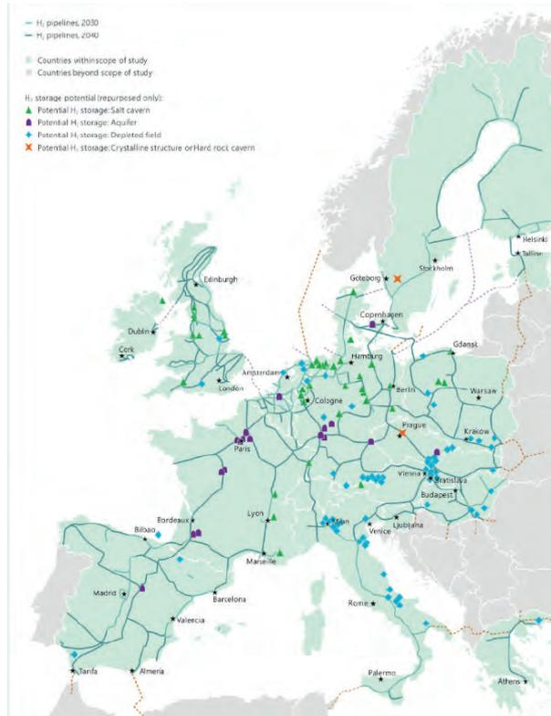
Le analisi condotte prevedono l'uso degli stoccaggi sotterranei di idrogeno potranno progressivamente mitigare la volatilità della crescente produzione di FER e fornire flessibilità al sistema. In particolare, gli stoccaggi sotterranei offriranno molteplici benefici al sistema energetico in termini di:
