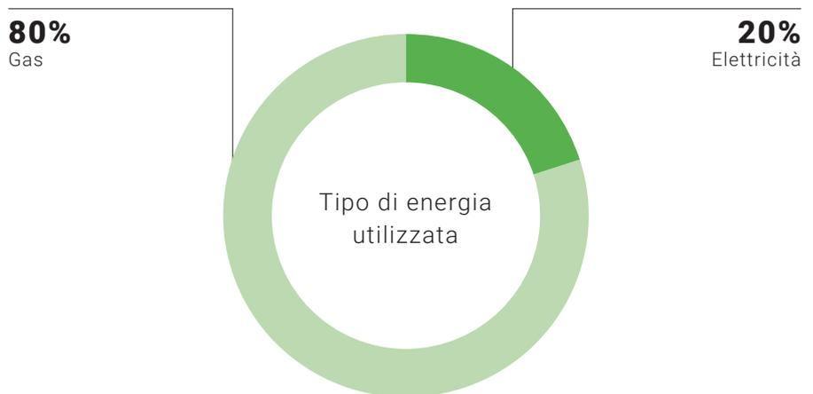
*Il processo di fusione incide per un valore > 70% dei consumi di energia primaria dell’intero stabilimento*
