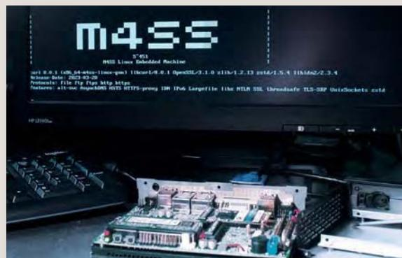
l'Industrial IoT denominato S451. Si tratta di un sistema per la raccolta, la selezione, l'analisi in loco e il trasferimento in cloud o on premise dei big data generati dalle macchine industriali. Basato su tecnologia open source, S451 è in grado di aggiornare il sistema da remoto ma anche di inviare notifiche, prendere decisioni, fermare le macchine quando necessario.
