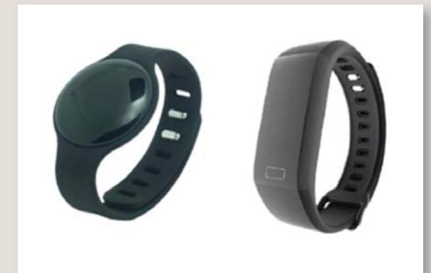
privacy. Rispetto alla versione precedente (4d TAG), 4D Watch registra i contatti ed è interconnesso ad una APP che consente di gestire e configurare il device ed eventualmente scaricare i contatti memorizzati. Grazie all'installazione di antenne, il rilevamento dei contatti avviene in tempo reale.
